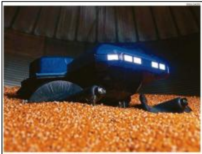
Robô Train Vreevil, disponível há um mês no país, evita a necessidade de o trabalhador entrar nos sítios
